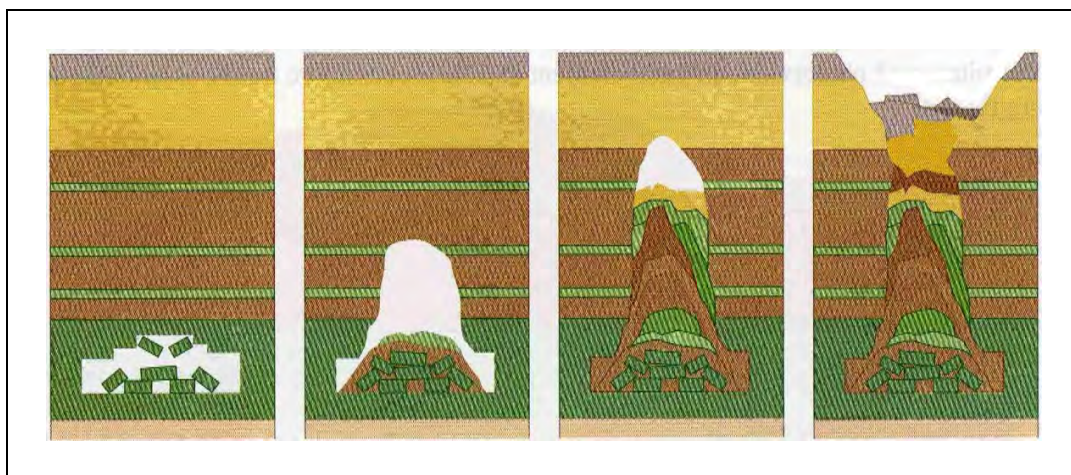
Figure 10 : Schéma de principe d'évolution d'un effondrement localisé (d'après « Évaluation des Aléas liés au Cavités Souterraines » – Guide méthodologique LCPC/INERIS 2002).
